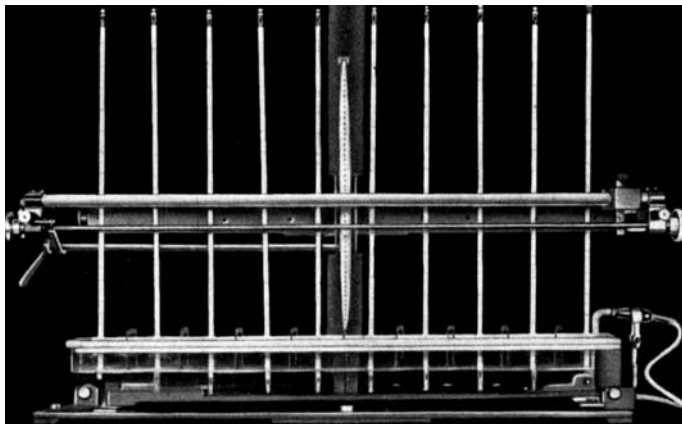
Abb. 2. Apparatur zum Eindampfen von Salzlösungen im Temperaturgefälle
